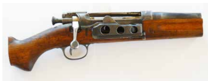
Instruksjonsmodell av Krag Jørgensen. Den er ikkje større enn det du ser på bildet. Hola i magasinlokket er for at folk skal kunne sjå kva som skjer i magasinet under mating av patroner.
