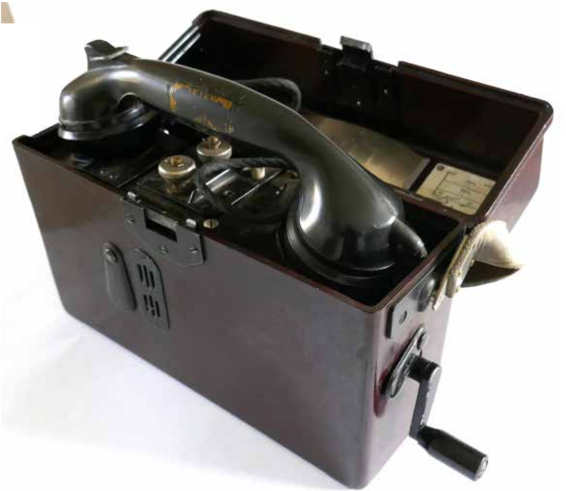
Det kom mange slike tyske felttelefonar til skyttarlag rundt om. Med store batteri vart dei eit nyttig hjelpemiddel før elektronikken gjorde sitt inntog.
