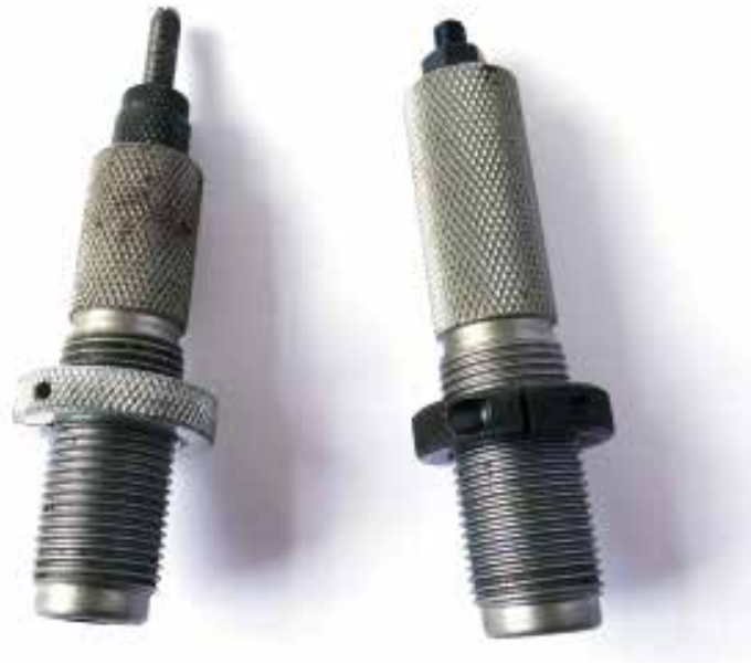
Viktigaste verktøy ein skyttar har. Hylsepresse og kuleisettar.
